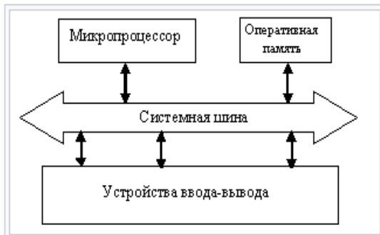
Рисунок 2. Простейшая схема взаимодействия оперативной памяти
